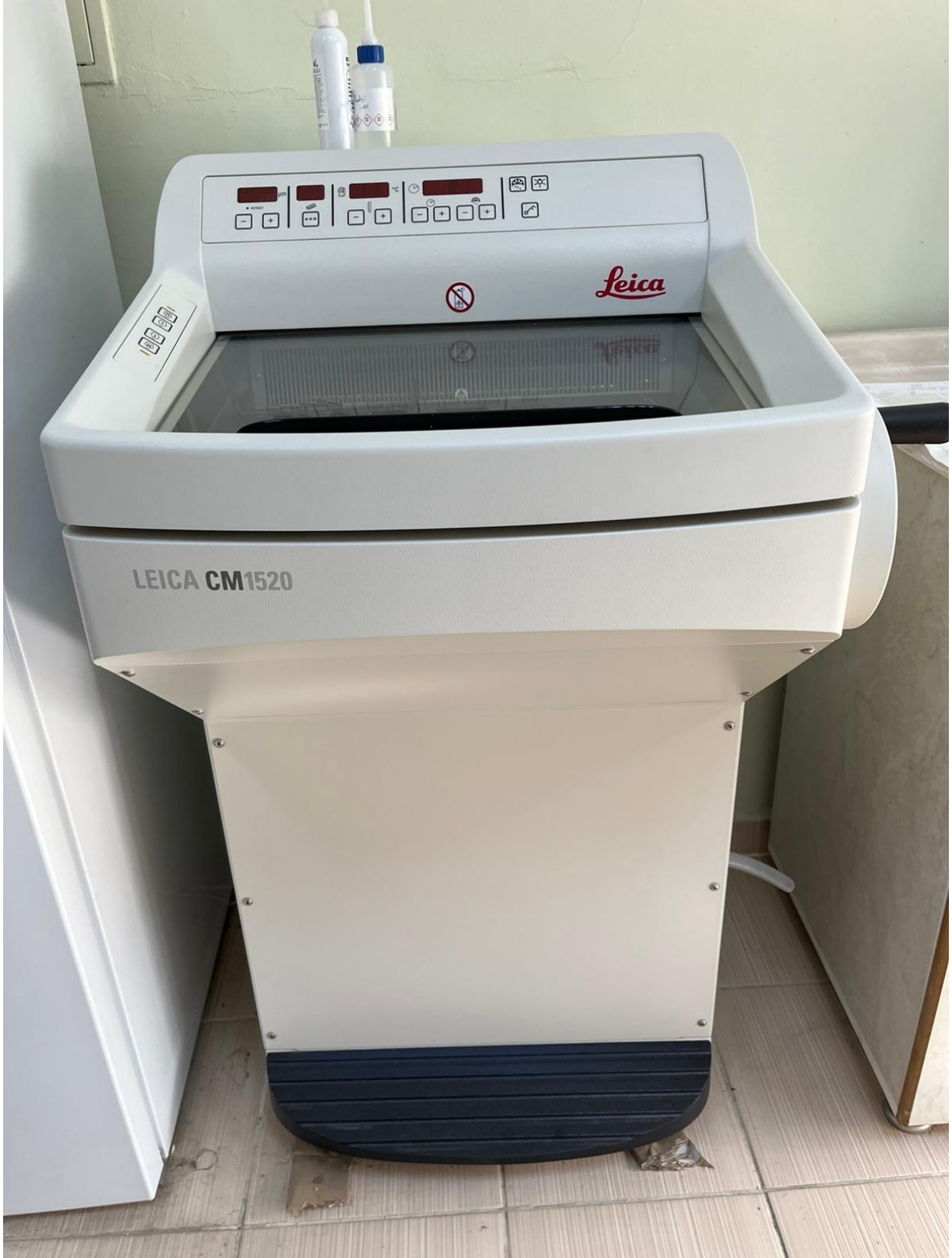
Leica CM 1520 kriyostatlı mikrotom
